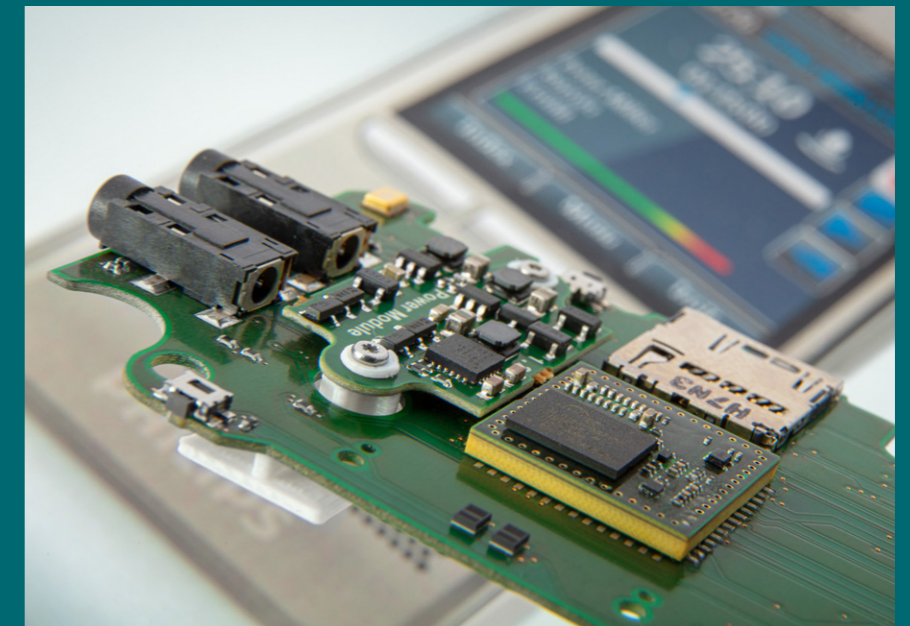
Abbildung 15: Modularisierter Aufbau einer Leiterplatte (Foto: Fraunhofer IZM, Volker Mai)
